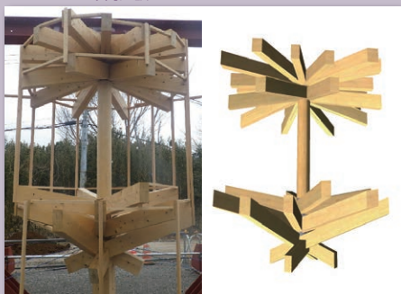
3D モデルとサンプルによる柱の検討 (日本平夢テラス) ©2018 木内建設
